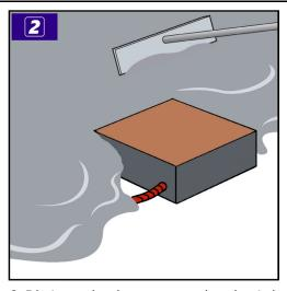
2. Die Leerrohre bzw. entsprechenden Leitungen sind vorab vorzubereiten / zu legen. Befestigen Sie die Leitungen bevor der Estrich verlegt wird.
