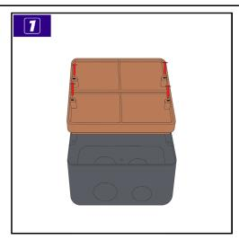
1. Bei der Platzierung des Bodentanks ist die Bodenhöhe zu beachten. Die Montage-Box |9| kann optional auf ein Mörtelbett gesetzt werden. Die Box muss mit einer Wasserwaage ausgerichtet werden. Die Höhe des Mörtelbetts muss so vermessen werden, dass der Abstand zwischen dem Rand der Box |9| und Estrich so groß ist, wie die spätere Boden-Belagsstärke. Zudem muss das Mörtelbett für die entsprechende Belastung der Bodensteckdose ausgelegt sein.
